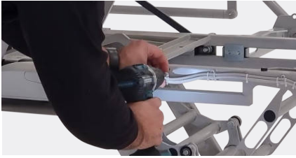
Step 13: Loosen cable.
