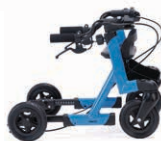
verstellbarer Radstand (optional)
